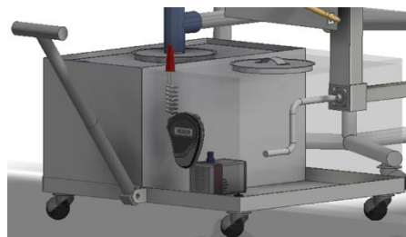
Gambar 3.33 Reservoir Tank dan Penempatan Komponen di dalamnya
