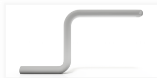
Gambar 3.5 Desain 3D Tuas engkol fitur tambahan pada perancangan Bed
