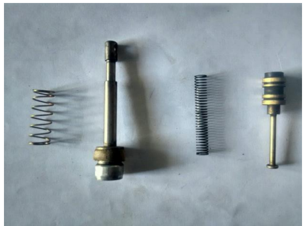
Gambar 4.8 Memeriksa pump plunger dan power piston
