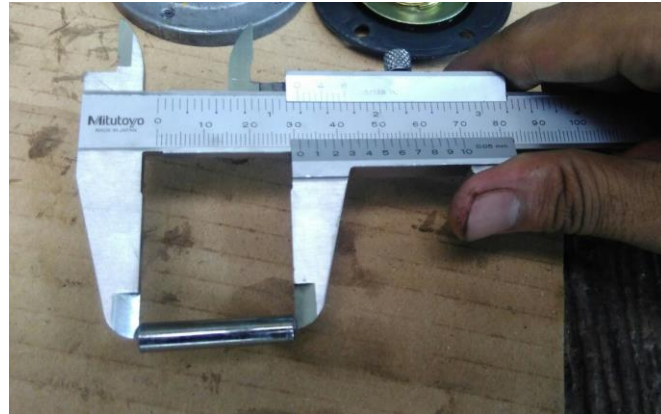
Gambar 4.2 Pengukuran panjang push rod
