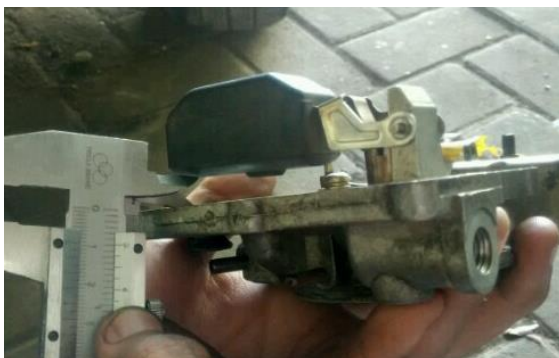
Gambar 4.6 Penyetelan pelampung posisi turun (distel menggunakan filler gauge dengan ukuran 0,8mm)
