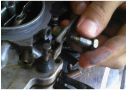
Gambar 3.7 Melepas baut pump plunger (melepas dengan menggunakan kunci pas 12)
