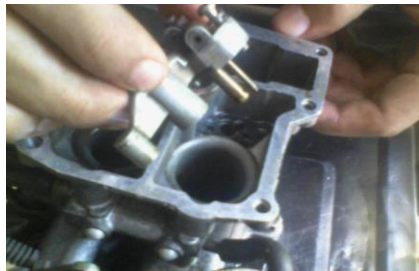
Gambar 3.18 Melepas Venturi primary dan secondary (lepas venturi primer & secondar menggunakan obeng plus)
