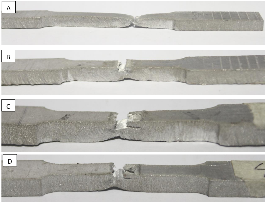
Gambar 4.9 Patahan Uji Tarik Tampak Samping Dengan Variasi Panjang Pin (a) raw material, (b) Pin 4,2 mm, (c) Pin 4,5 mm, dan (d) Pin 4,8 mm
