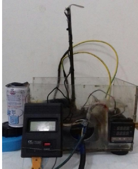
Gambar 3.14. Alat uji flash point
