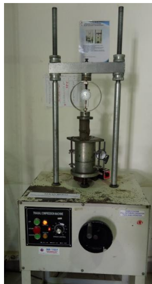
Gambar 3.8. Proses pengujian tekan bebas.
