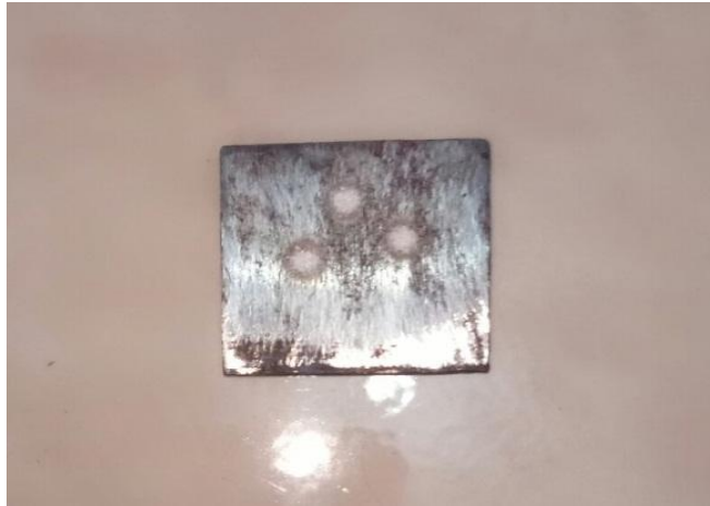
Gambar 4.2 Spesimen pengujian setelah dilakukan uji komposisi
