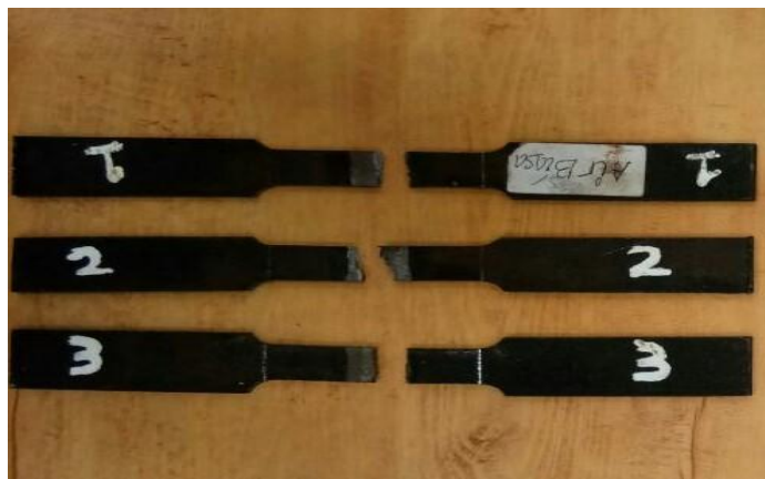
Gambar 4.4 Spesimen setelah dilakukan pengujian tarik
