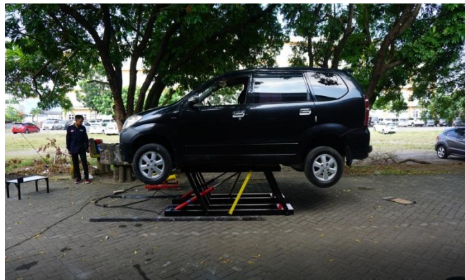
Gambar 7.6 Uji Coba Portable Electric Hydraulic Jack Pada Mobil Avanza
