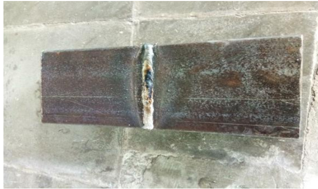
Gambar 6.4 Hasil Pengelasan SMAW Pada Baja Karbon Rendah
