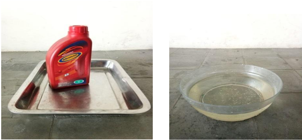
Gambar 6.1 Media Pendingin Pengelasan SMAW
