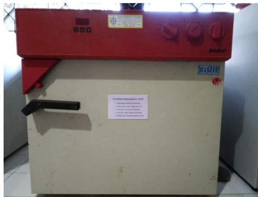
Gambar 3.4 Oven untuk mngeringkan agregat
