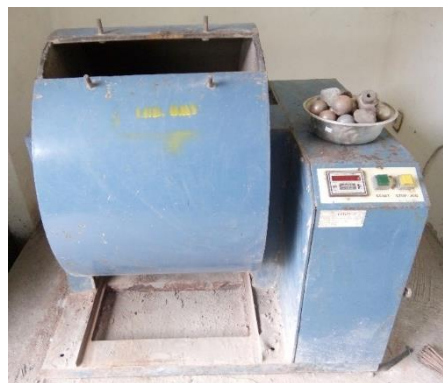
Gambar 3.5 Mesin penguji keausan
