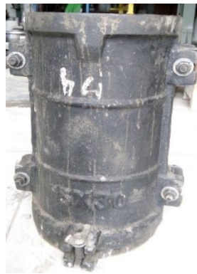
Gambar 3.9 Cetakan Silinder benda uji
