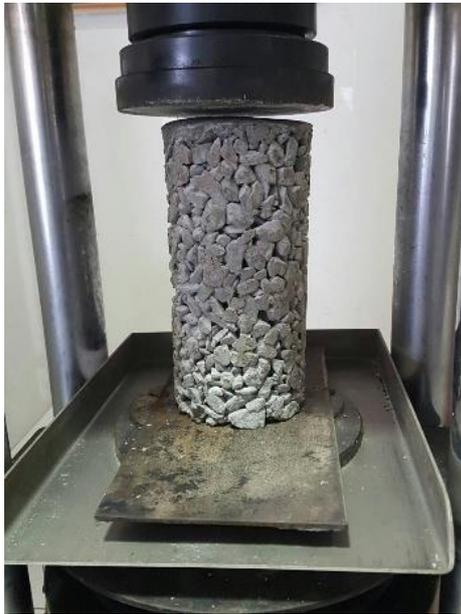
Gambar 7. Benda uji sebelum di uji tekan
