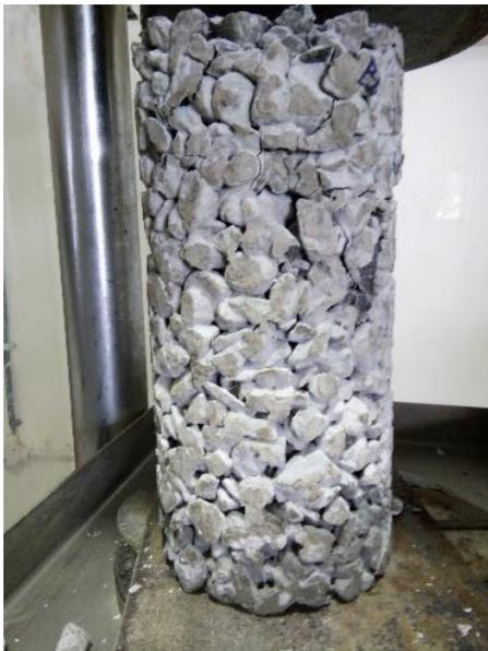
Gambar 8. Benda uji Setelah di uji tekan
