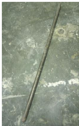
Gambar 3.8 Batang penumbuk pelengkap kerucut abhrams
