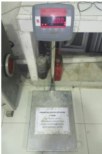
Gambar 3.4 Timbangan digital yang memiliki ketelitian 5 gram
