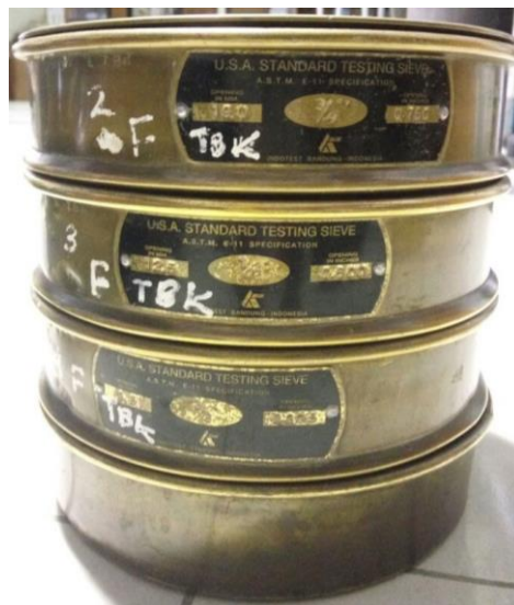
Gambar 3.3 Ayakan berukuran 9,6 mm (nomor 3/8"), 12,7 mm (nomor 1/2") dan 19,6 mm (nomor 3/4")
