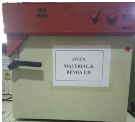
Gambar 3.1 Oven dengan suhu maksimal 220^{\circ}\text{C}
