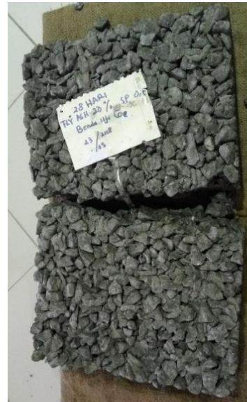
Gambar 6.2 Benda uji fly ash 20% sesudah diuji kuat lentur
