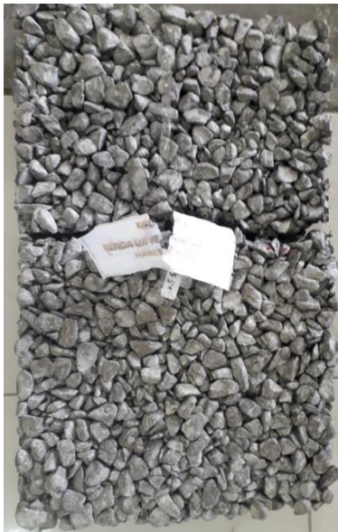
Gambar 6.1 Benda uji fly ash 0% sesudah diuji kuat lentur
