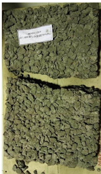
Gambar 6.3 Benda uji fly ash 40% sesudah diuji kuat lentur
