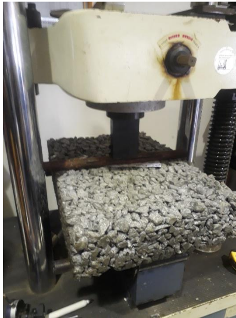
Gambar 6.5 Benda uji dalam proses pengujian kuat lentur
