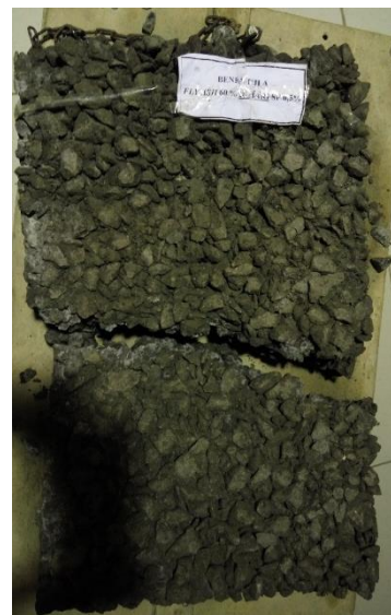
Gambar 6.4 Benda uji fly ash 60% sesudah diuji kuat lentur
