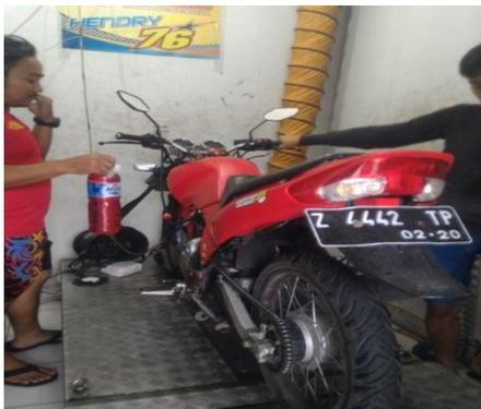
**Gambar 2.3** Proses pengujian *dynotest* menggunakan *dynamometer*
