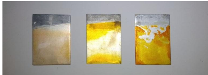
Gambar 4.1 Kegagalan hasil dari proses dyeing menggunakan perasan kunyit
