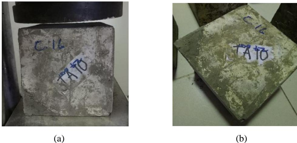
Gambar 4.2 Benda uji sebelum dan sesudah diperbaiki dengan fas 0.28: (a) Beton sebelum diperbaiki (b) benda uji sesudah diperbaiki dengan fas 0,28
