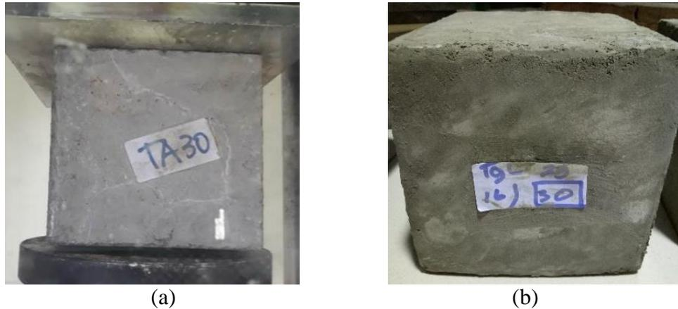
Gambar 4.3 Benda uji sebelum dan sesudah diperbaiki dengan fas 0.28: (a) Beton sebelum diperbaiki (b) benda uji sesudah diperbaiki dengan fas 0,28
