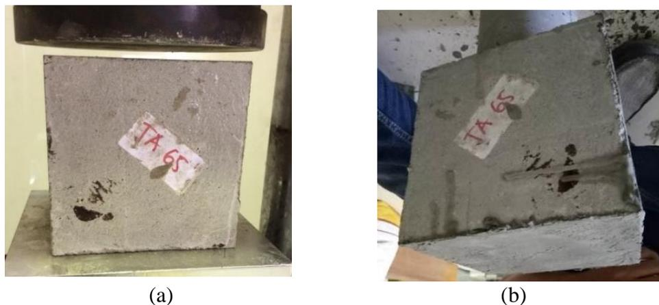
Gambar 4.4 Benda uji sebelum dan sesudah diperbaiki dengan fas 0.28: (a) Beton sebelum diperbaiki (b) benda uji sesudah diperbaiki dengan fas 0,28.
