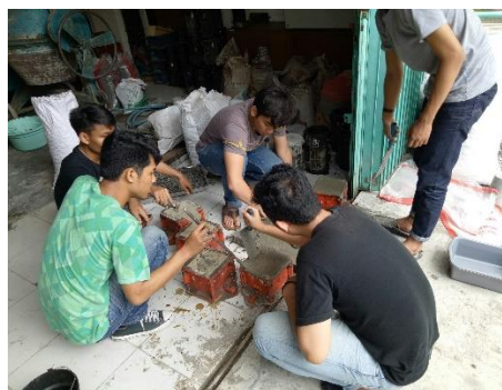
Gambar 25 Penuangan Beton Segar
