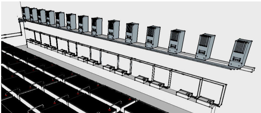
Gambar 4.6. Desain Ruang Baterai , SCC, dan Inverter
