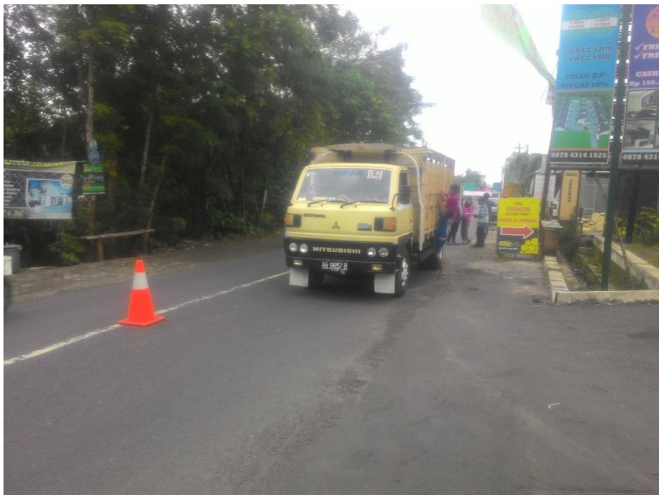
Gambar 6.6 Truck sebagai beban uji
