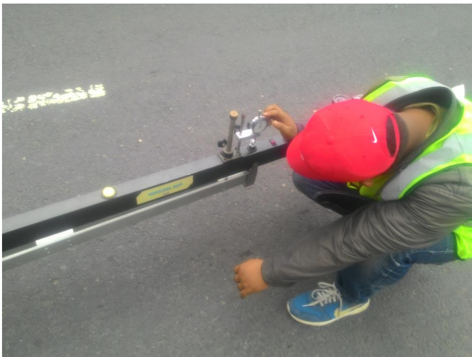
Gambar 6.8 Pengaturan alat Benkelman Beam
