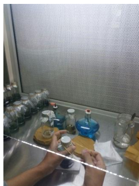
Pembungkusan botol menggunakan kertas aluminium foil
