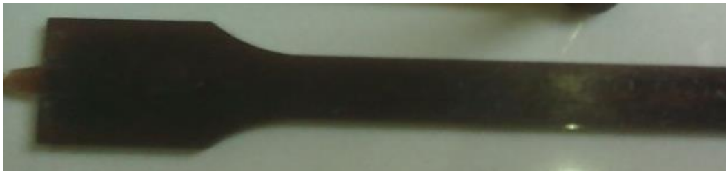
Gambar 4.8. Spesimen dengan serat kenaf yang gosong
