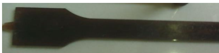
Gambar 3.4 Spesimen dengan serat kenaf yang gosong
