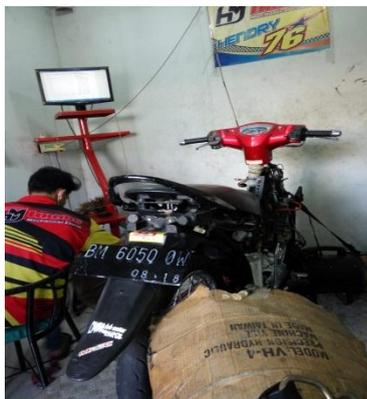
Gambar 3. 21 Posisi sepeda motor di *dynamometer*
