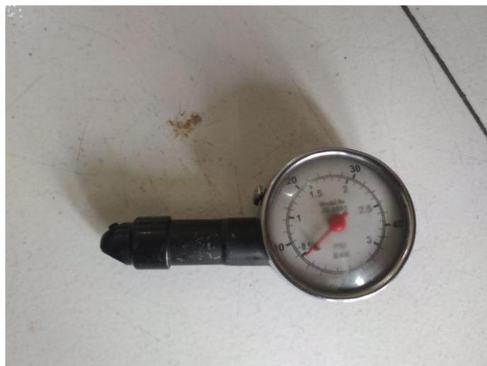
Gambar 3. 12 Tire Pressure Meter
