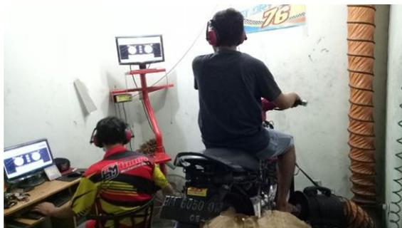
Gambar 3. 22 Pengujian daya dan torsi
