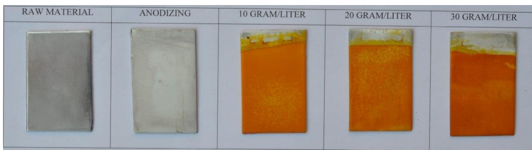
Gambar 4.2 Hasil anodizing menggunakan variasi konsentrasi pewarna kunyit
