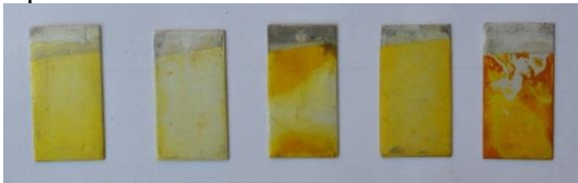
Gambar 2 Kegagalan dari proses dyeing pada proses anodizing
