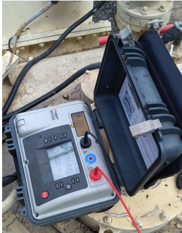
Gambar 2.26 alat ukur Insulating meter (megger) Sumber: Dokumen Penelitian di PLTU 1 PACITAN
