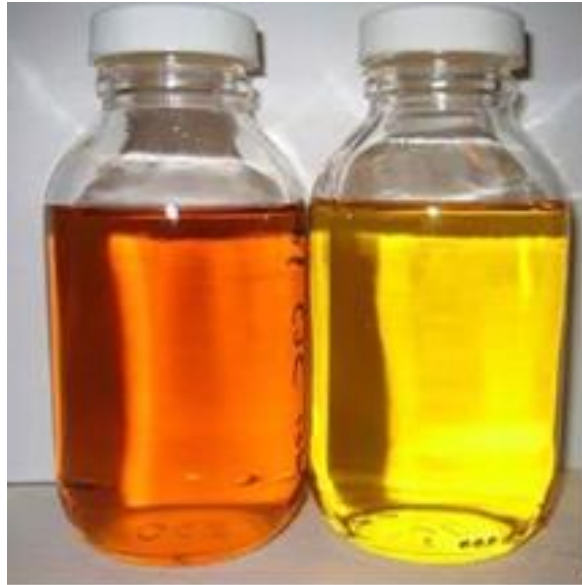
Gambar 2.16 Minyak isolasi Trafo
