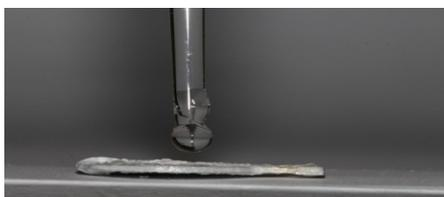
Gambar 3 Percobaan aluminium *hidrofobik*.
