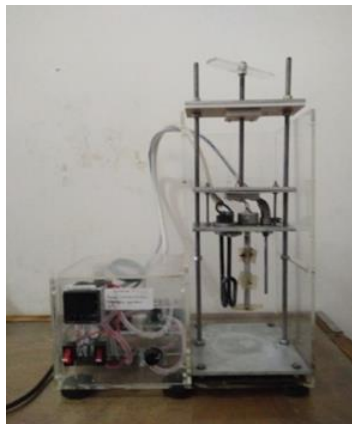
Gambar 4. Alat pemanas dan pengaduk minyak
