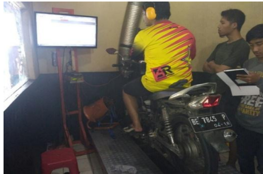
Gambar 3.18 Alat uji torsi dan daya dengan dynamometer
