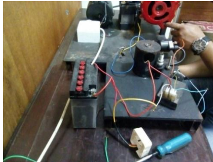
Gambar 2.2 Proses pengujian percikan bunga api
