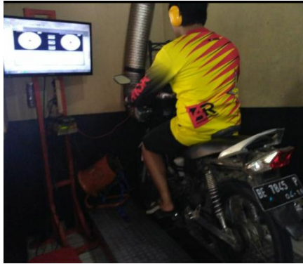
Gambar 2.3 Proses pengujian dynotest menggunakan dynamometer
