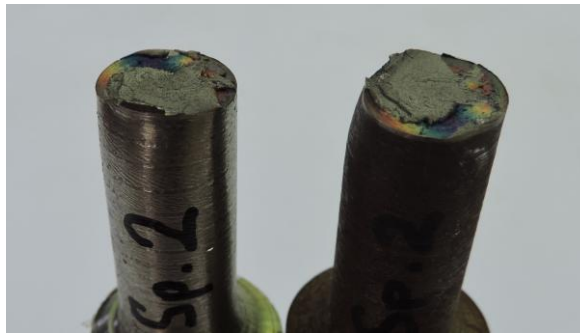
Gambar 4. 18 Permukaan patahan variasi waktu gesek 6 detik
