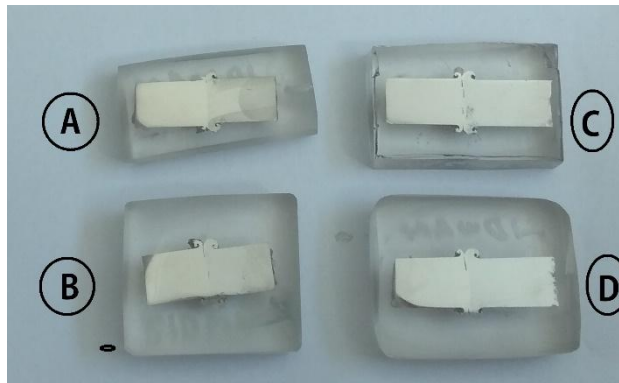
Gambar 4. 7 Spesimen pengujian nilai kekerasan; (A) waktu gesek 3 detik, (B) waktu gesek 6 detik, (C) waktu gesek 9 detik, (D) waktu gesek 12 detik.
