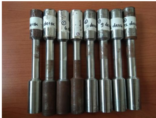
Gambar 4. 11 Spesimen pengujian kekuatan tarik
