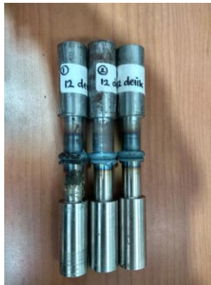
Gambar 4. 4 Hasil penyambungan dengan waktu gesek 12 detik.
