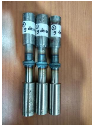
Gambar 4. 3 Hasil penyambungan dengan waktu gesek 9 detik.
