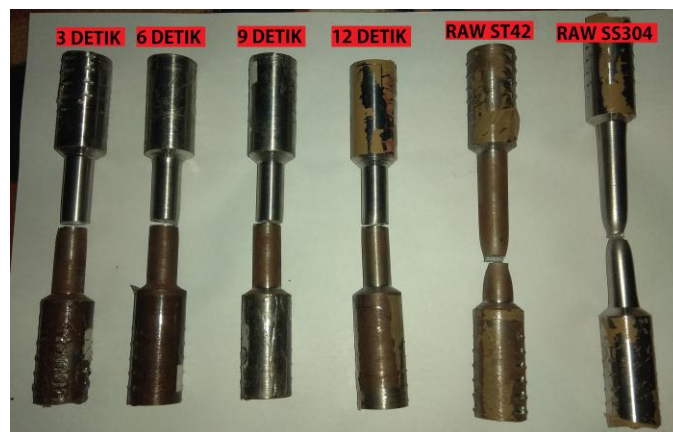
Gambar 4. 16 Hasil patahan proses pengujian tarik
