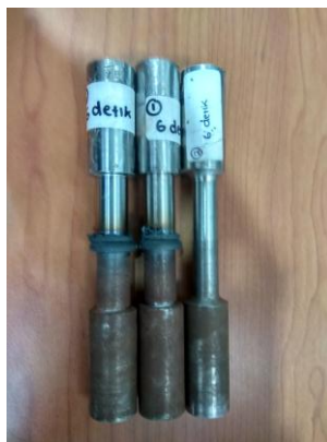
Gambar 4. 2 Hasil penyambungan dengan waktu gesek 6 detik.
