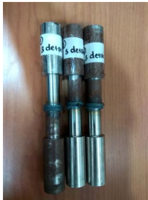
Gambar 4. 1 Hasil penyambungan dengan waktu gesek 3 detik.
