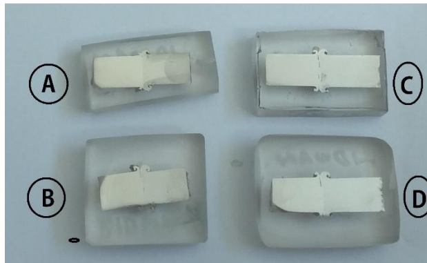
Gambar 4. 6 Spesimen pengujian struktur mikro; (A) waktu gesek 3 detik, (B) waktu gesek 6 detik, (C) waktu gesek 9 detik, (D) waktu gesek 12 detik.
