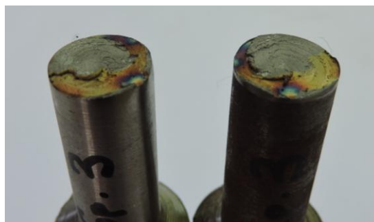
Gambar 4. 19 Permukaan patahan variasi waktu gesek 9 detik
