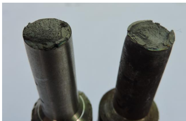
Gambar 4. 17 Permukaan patahan waktu gesek 3 detik
