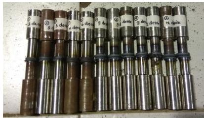
Gambar 6. Hasil pengelasan gesek silinder pejal *stainless steel* 304 dan baja karbon rendah ST 42
