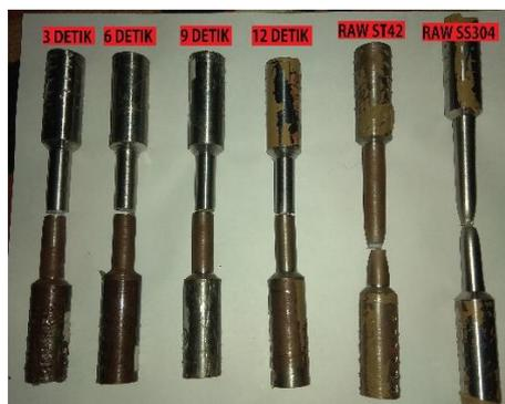
Gambar 13. Hasil patahan spesimen setelah proses pengujian tarik
