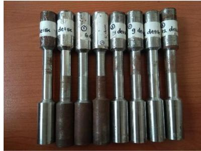
Gambar 5. Spesimen pengujian tarik sesuai standar JIS Z 2201:1998
