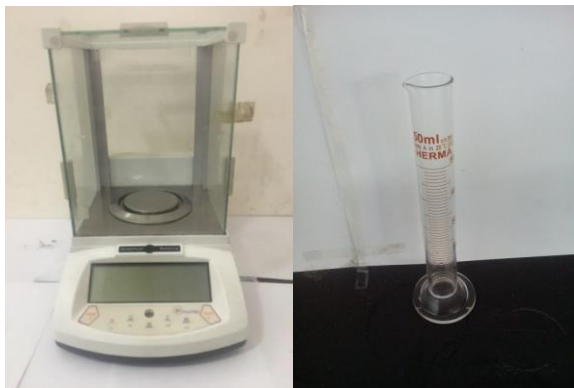
Gambar 3.15 Timbangan dan Gelas ukur untuk Pengujian Densitas
