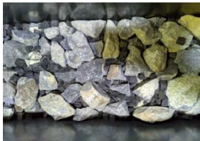
Gambar 3. 9 Susunan benda uji balas dan potongan karet ban bekas
