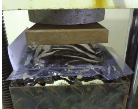
Gambar 3. 16 Benda uji yang mengalami penurunan setelah diuji
