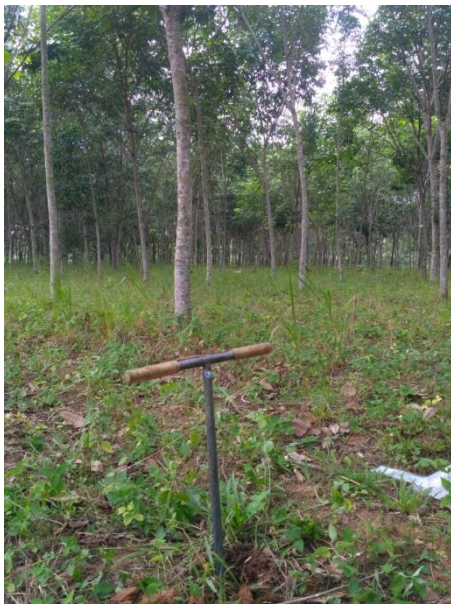
(b). Pengeboran Tanah untuk Mengambil Sampel Tanah dan Sampel Tanah setelah di komposit.
