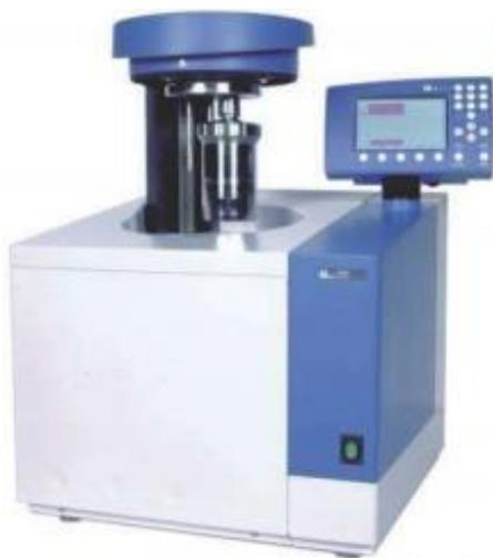
Gambar 3.16. *Bomb Calorimeter*
