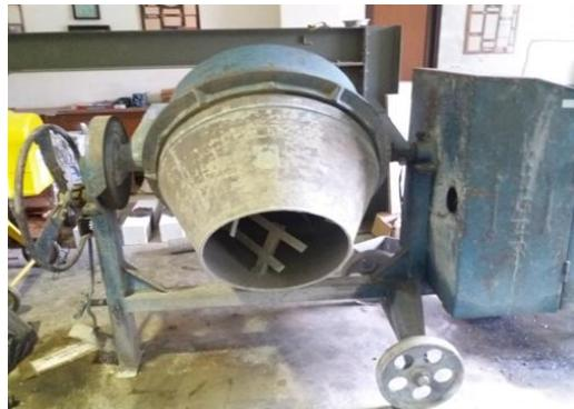
Gambar 7 Mixer dengan kapasitas 50 kg
