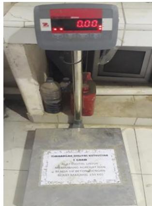
Gambar 4 Timbangan Digital dengan ketelitian 5,0 gram
