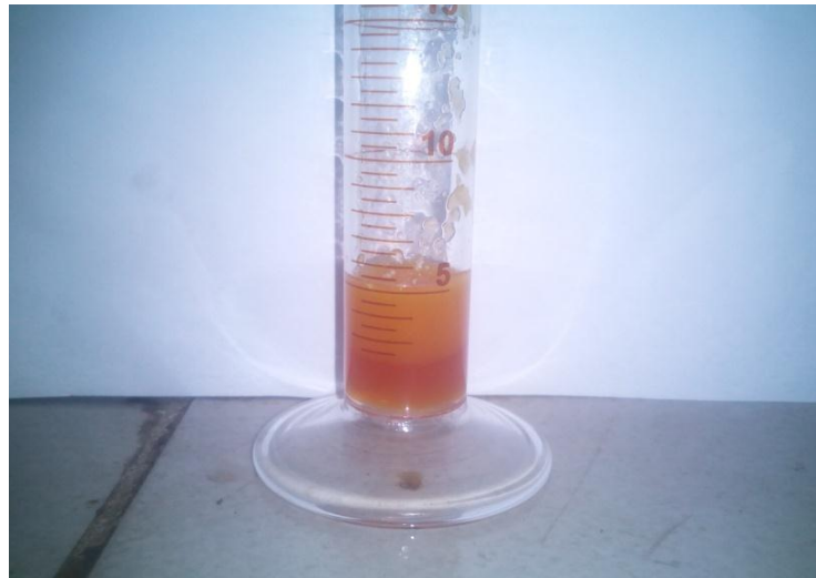
Gambar 12. Crude Gliserol yang Encer dan Memadat dalam Gelas Ukur Sebanyak 5 ml
