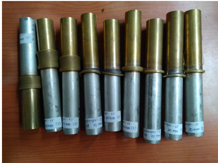
Gambar 4.1. Hasil sambungan pengelasan gesek pipa stainless steel 304 dengan pipa kuningan
