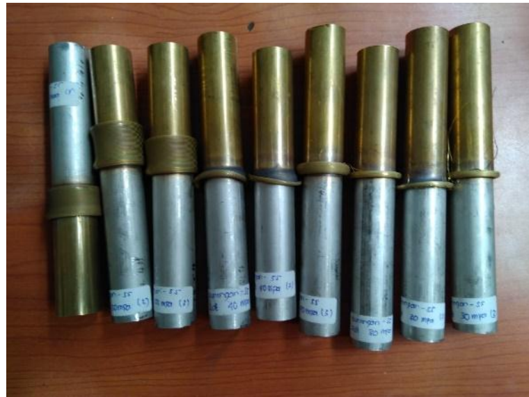
Gambar 5. Hasil pengelasan pipa stainless steel 304 dengan pipa kuningan
