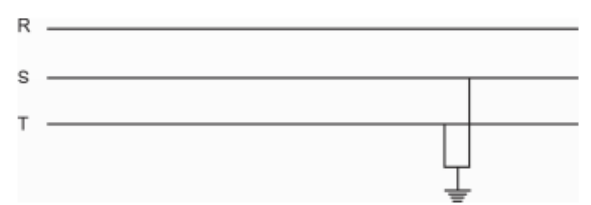
Gambar 4. Gangguan 2 Fasa Ke Tanah
