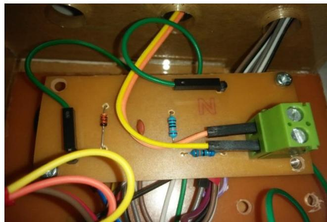
Gambar 4.6 Alat Pengukur Tegangan
