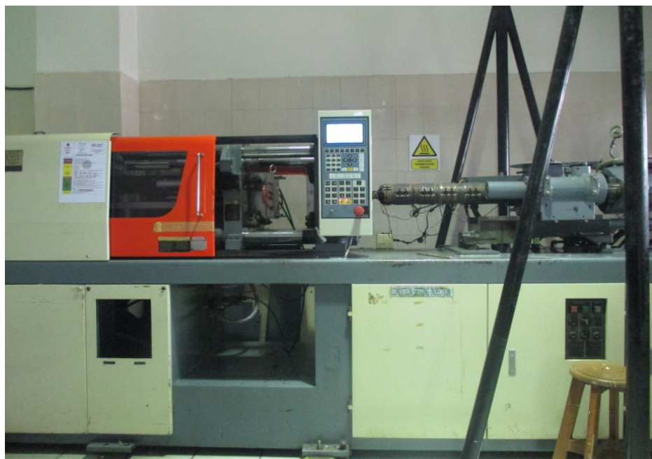
Gambar 3.2 mesin injeksi molding
