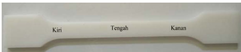
Gambar 3. 16 Pengukuran ketebalan, dan lebar spesimen
