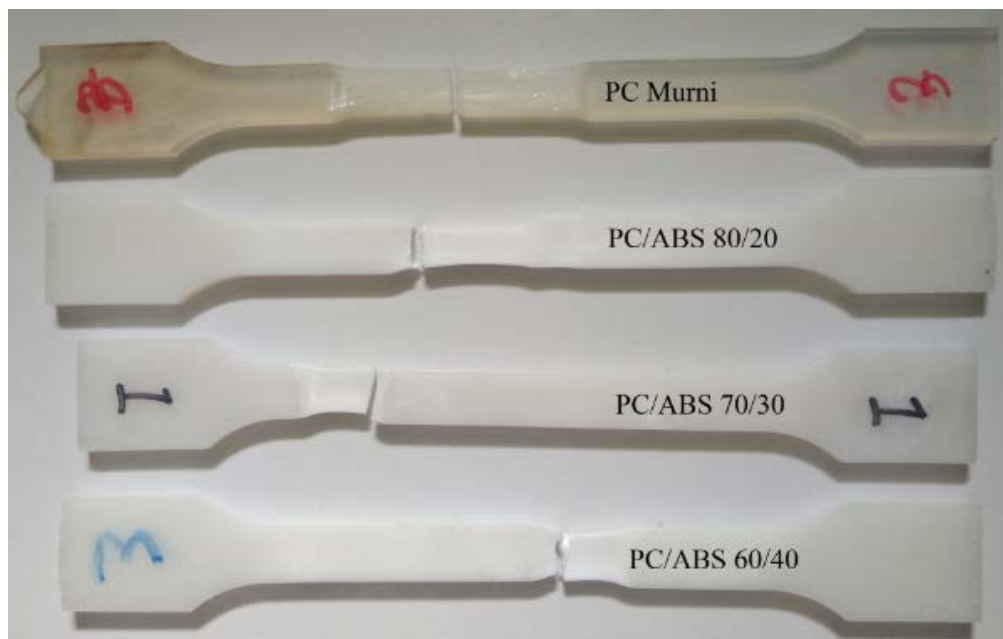
Gambar 4.5 Spesimen hasil pengujian tarik
