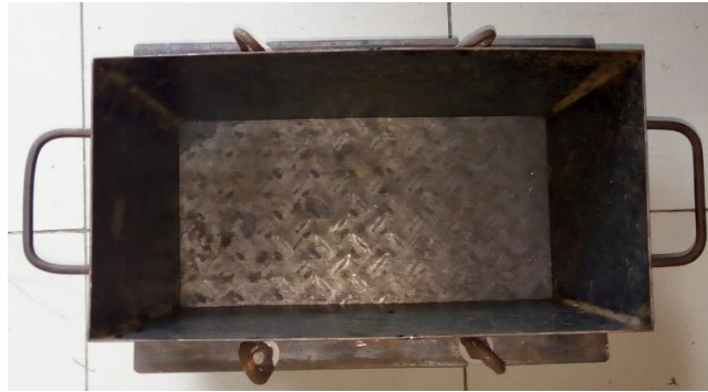
Gambar 3.2 Box Cetakan Benda Uji Tampak Atas
