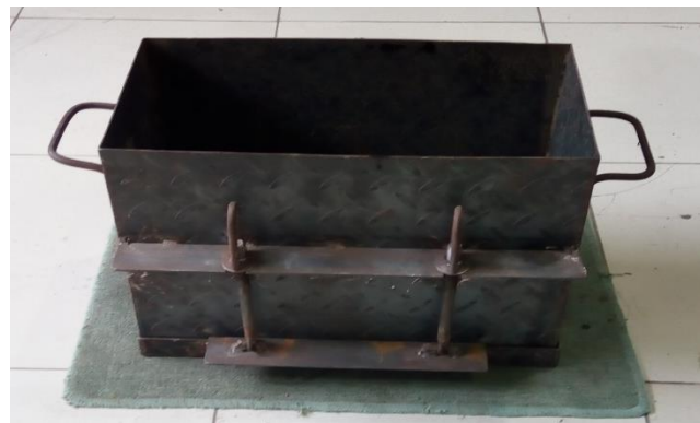
Gambar 3.3 Box Cetakan Benda Uji Tampak Samping
