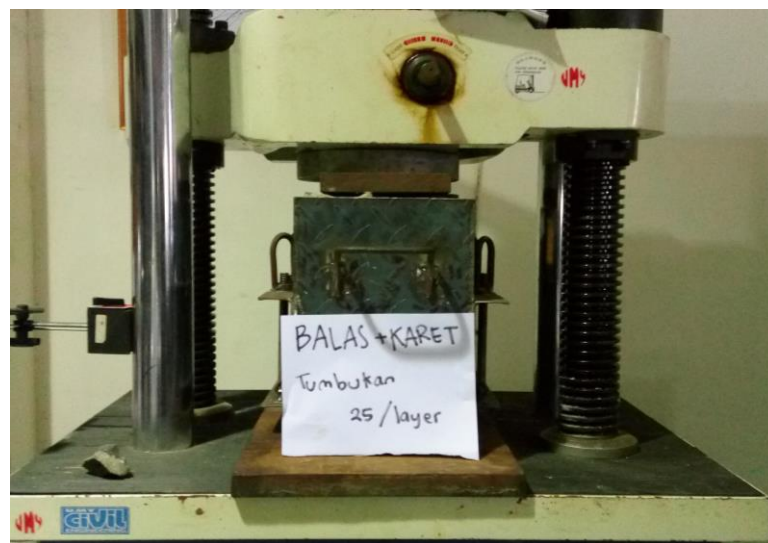
Gambar 3.11 Memasang Benda Uji Pada Alat Uji Tekan
