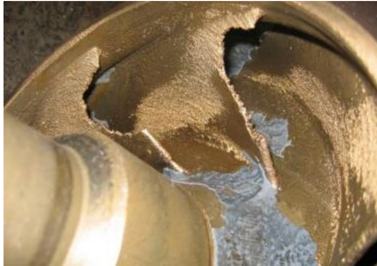
Gambar 2.23 Impeller cacat yang disebabkan kavitasi (Kamiel, 2015)
