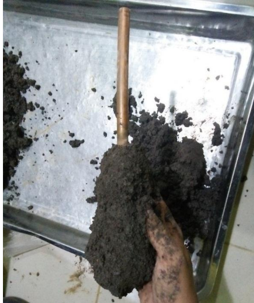
Gambar 4.16. Penggumpalan tanah pada ara di sekitar katoda (-).
