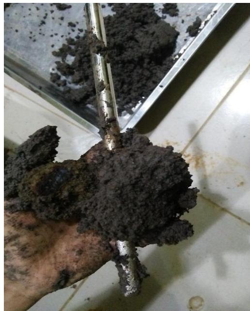
Gambar 4.17. Penggumpalan tanah pada area di sekitar anoda (+).
