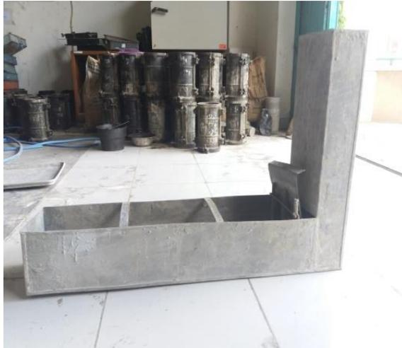
Gambar 3.3 Alat pengujian *L-Box*
