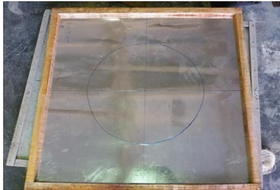
Gambar 3.1 Alat pengujian Meja Sebar (T50)
