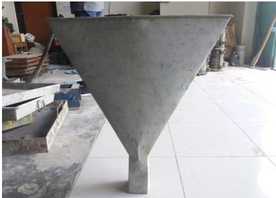
Gambar 3.2 Alat pengujian *V-Funnel*
