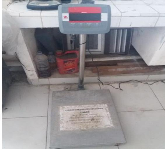
Gambar 3.5 Timbangan digital dengan ketelitian 5 gram
