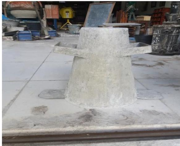
Gambar 3.12 Kerucut *Abrams*
