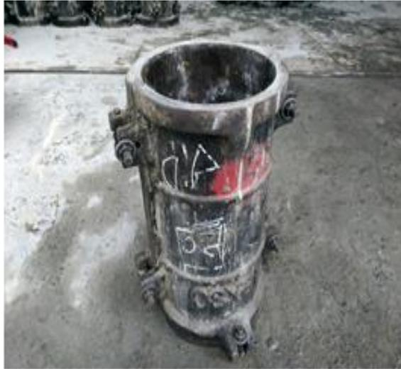
Gambar 3.9 Silinder cetakan beton
