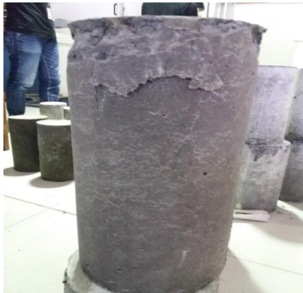
Gambar 31 beton setelah dilakukan uji tekan
