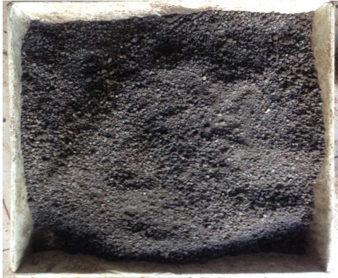
Gambar 3.11 Tanah yang sudah dicampur air.
