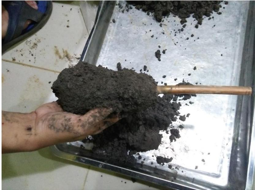
Gambar 4.18 Tanah pada katoda pasca pemberian elektrokinetik dan kolom kapur.
