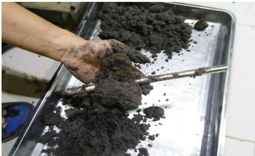
Gambar 4.17 Tanah pada anoda pasca pemberian elektrokinetik dan kolom kapur.
