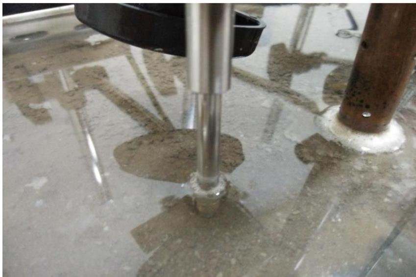
Gambar 4.16 Fenomena elektrolisis pada elektroda.
