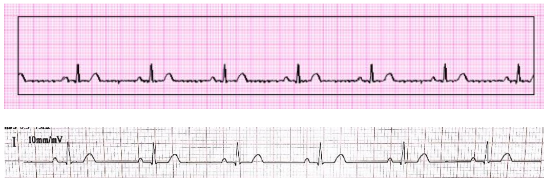
Gambar 4. 13 Pengukuran lead I pada modul ECG (atas), pengukuran ECG standar (bawah)
