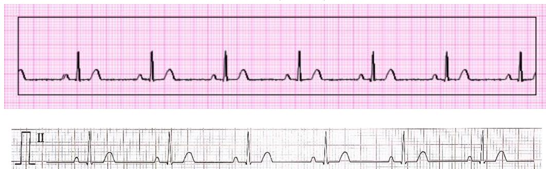
Gambar 4. 13 Pengukuran lead I pada modul ECG (atas), pengukuran ECG standar (bawah)
